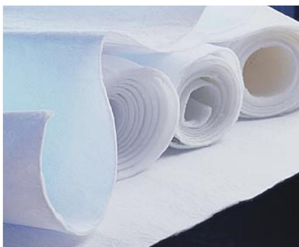
Figura 4.17 – Material de isolamento de aerogel em forma de manta (Baetens *et al.*, 2011).
